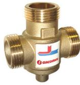
Thermisches Mischventil zur Rücklaufanhebung aus Messing mit AG, flachdichtend für Festbrennstoffkessel. Dient zur Anhebung der Rücklauftemperatur. Durch die optimale Kesselrücklauftemperatur werden Taupunktunterschreitungen, abgasseitige Korrosion und Glanzrußbildung verhindert, was zu einer Verlängerung der Lebensdauer des Heizkessels und weniger Umweltbelastung führt.
