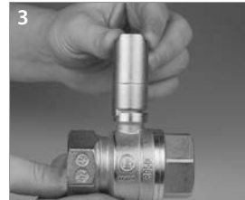
3 Die zylindrische Verlängerung, die auf der Spindel des Kugelhahns montiert werden soll, unter Beachtung der Öffnungsrichtung anbringen.
