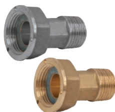
Verbindungsstück für Wasserzähler. Temperaturbereich: 5 ÷ 110 °C Maximaler Betriebsdruck: 10 bar
