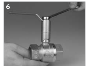
6 Den Hebelgriff montieren und die Mutter mit einem geeigneten Schlüssel festziehen.
