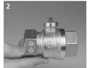
2 Den Hebelgriff abnehmen und die neue PTFE-Manschette (im Lieferumfang inbegriffen) einsetzen, ohne die vorhandene Manschette zu entfernen.
